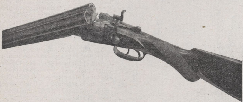
Nr 451. Dubbelgevär. Toppleversystem, dubbelslutare. Stålpipor fint grave- rade, från mynningen till kamrarna damastimiterade. Kamrarna svarta, fint gra- verade. Tvärreftad siktbygga. Tillbakaspringande hanar med vacker gravyr. Framliggande prima låsar, fint graverade med guldinlägg. Kolv med pistolgrepp, nätskärning och kindputa. Reftad bakplåt. Ett ovanligt prydligt och bra gevär. Fås i kaliber 12 och 16. Vänstra loppet trångborrat. Pris: Kronor 46: 00.
