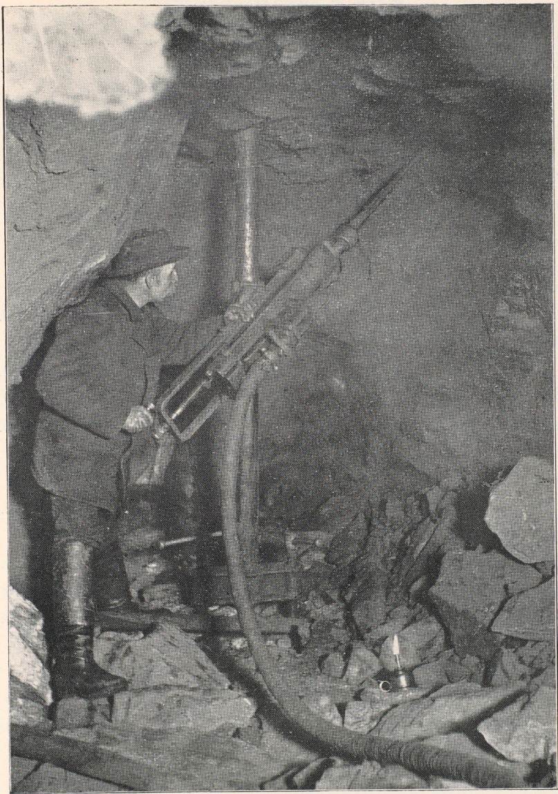
Morgårdshammars bormaskin, uppsatt på spännpelare för borning i ort, tunnel eller takstross.
