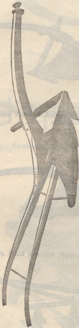
Fig. 22. Plog № 11, efter Howards modell, med ås och handtag af träd.
