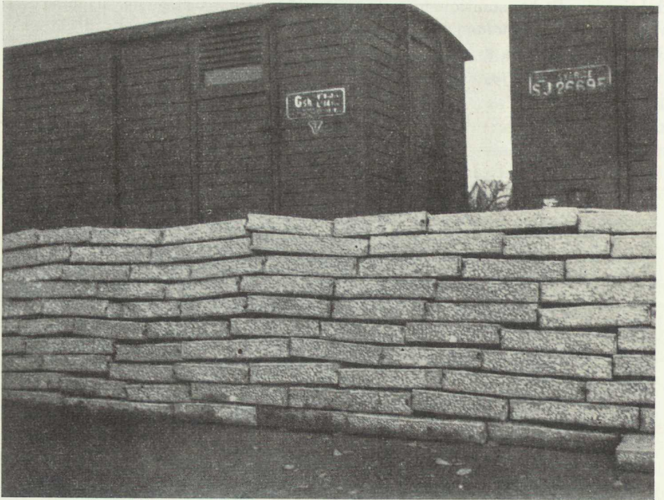
Råkantsten i upplag.
