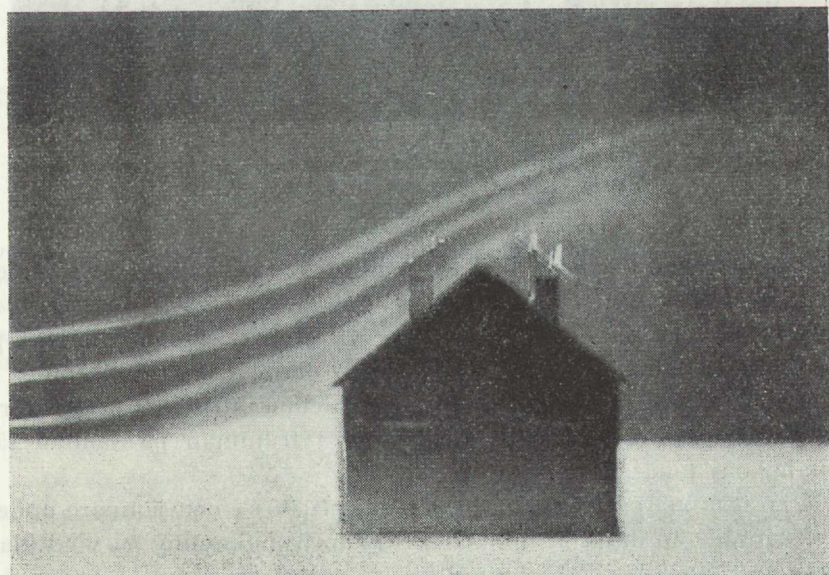
Fig. 34. Modellfotografi utvisande luftens strömning över modellbyggnaden.
