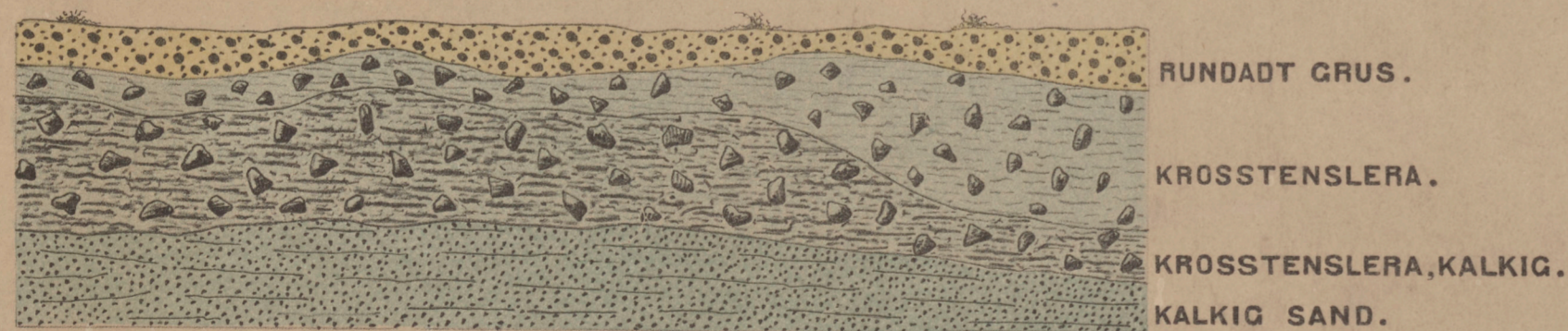
Fig. 4. Genomsnitt af lagren i ett mergeltag i södra Skåne. I Skåne förekommer en stenblandad och grusig lera, s. k. krostenslera, som motsvarar del af rikta landets vanliga krostensgrus. — Den är oftast i nedre delen kalkhaltig, och användes då, tillika med den underliggande, kalkiga sanden eller åliallsanden till åkerjordens mergeltag.
