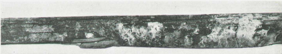
Fig. 19. Merulius lacrymans . Undersida av bräder under brandbotten (Prästgårdsgatan, Stockholm) jämte tvärsektion av skadad bjälke.
